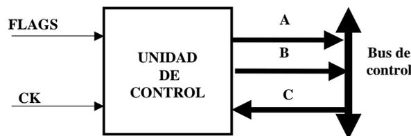
siendo A las señales de control internas de la C.P.U., B señales de control al bus de sistema y C las señales de control del BUS de sistema.
